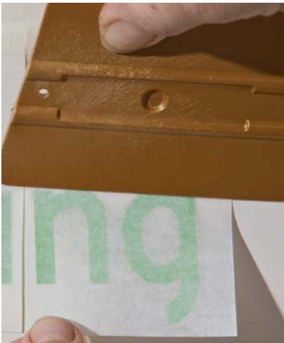
Das Trägerpapier so nach unten ziehen, dass Transfer- und Klebefolie noch leicht von der Fläche abstehen. Transfer- und Klebefolie nun mit flachem Gegenstand (Rakel, Eiskratzer, Massstab) von oben herab mit einander überlappenden Strichen fest anstreichen. Darauf achten, dass dabei auch möglichst alle Blasen herausgestrichen werden. Bei grossen Klebern von der Mitte her beginnen.
