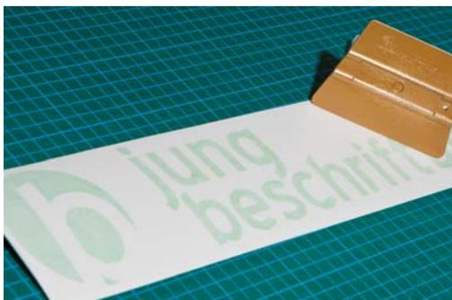
Direkt vor dem Verkleben Kleber mit Rakel sorgfältig und gründlich an Übertragungsfolie anreiben. Dadurch lösen sich auch kleine Teile wie i-Punkte besser von der Transferfolie.
