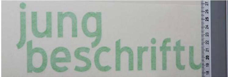
Um den Kleber exakt zu positionieren, wird auf der Transferfolie eine Hilfslinie eingezeichnet. Messen Sie diese Linie an den Klebelementen auf der Klebefolie ab (und nicht an der ganzen Klebefolie, falls der Rand der Folie etwas schräg geschnitten sein sollte).
