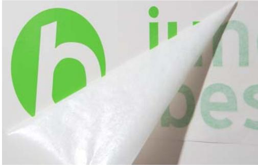
Danach die Transferfolie um 180° umklappen und möglichst nahe nach hinten abziehen. Dabei die Transferfolie immer wieder nachfassen. Tipp: Vor dem Abziehen die Transferfolie nochmals andrücken, die Qualität der Verklebung wird so noch besser.
