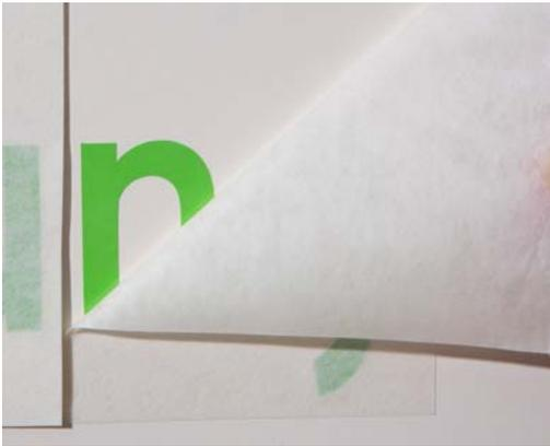
Danach die Transferfolie um 180° umklappen und möglichst nahe nach hinten abziehen. Dabei die Transferfolie immer wieder nachfassen. Tipp: Vor dem Abziehen die Transferfolie nochmals andrücken, die Qualität der Verklebung wird so noch besser.
