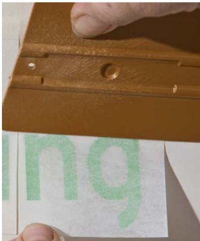
Die ganze Folie auf die Klebefläche klappen. Auf dem feuchten Untergrund kann die Klebefolie wenn nötig noch genauer positioniert werden. Nun mit flachem Gegenstand (Rakel, Filzrakel) von der Mitte her das Wasser restlos hinaus streichen.
